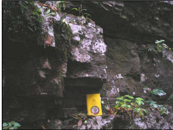
Foto 12: Hydrogeologische Wertigkeit, Typ 3: Kalk mit geschlossenen Klüften
