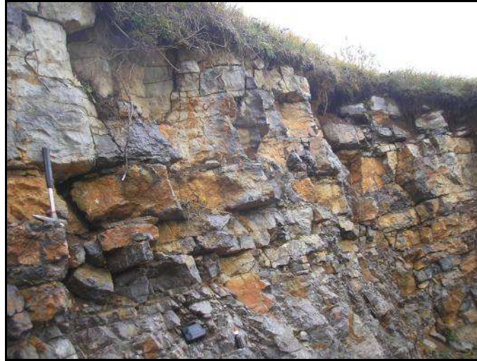
Foto 14: Hydrogeologische Wertigkeit, Typ 4: Kalk mit hoher Klufthäufigkeit und Verkarstungspotential
