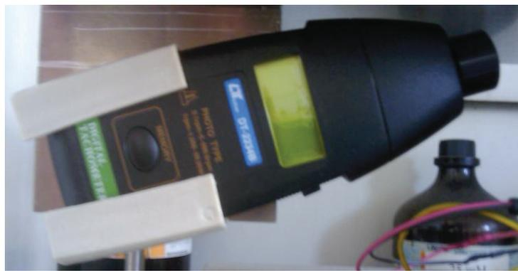
**Abb. 7: Drehzahlmessgerät. In einem Schaft montiert.**
