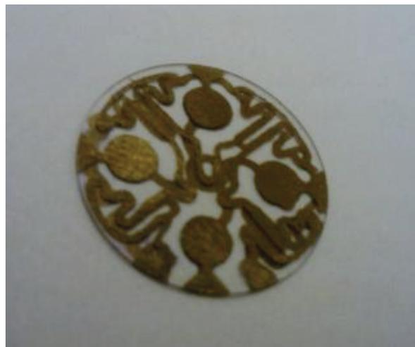
**Abb. 38: Das neue Layout der Elektroden mit Heizwendeln, die Kontaktoberflächen wurden stark reduziert. Die Heizwendeln sind doppelseitig.**
