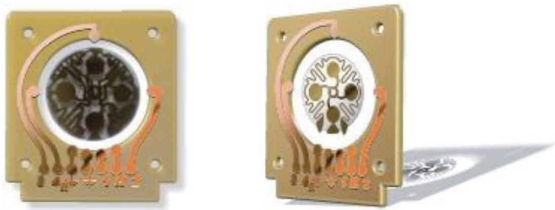
Abb. 85: Leiterplatte im fertigen Zustand mit Quarz in 3D Darstellung mit PC gerendert
