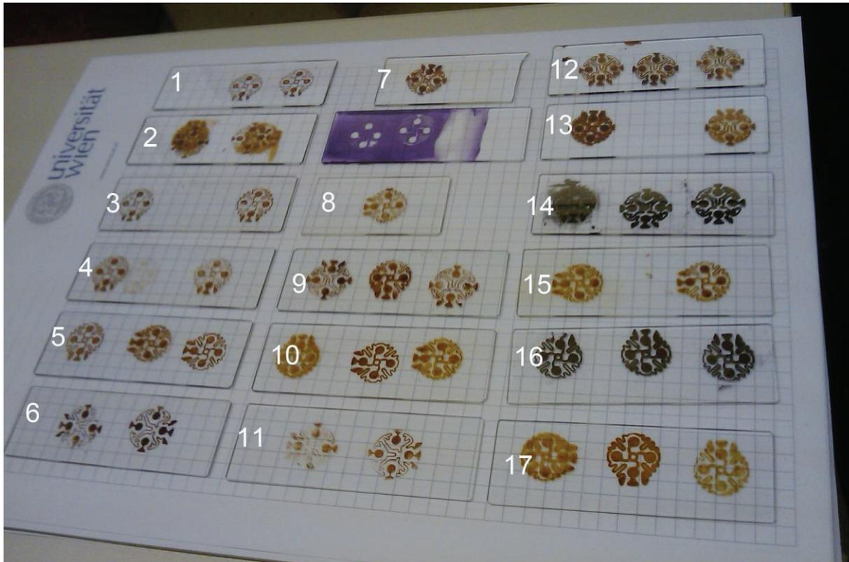
Abb. 36: Vergleich der Viskositäten Anhand der verwendeten Elektrodenmuster. Es wurden verschiedene Torcknungsgrade und Viskositäten auf Glas verglichen.
