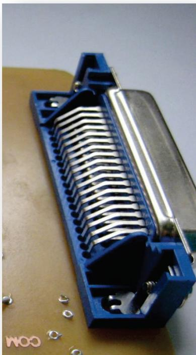
**Abb. 68: Anschluß der LPT Schnittstelle**
