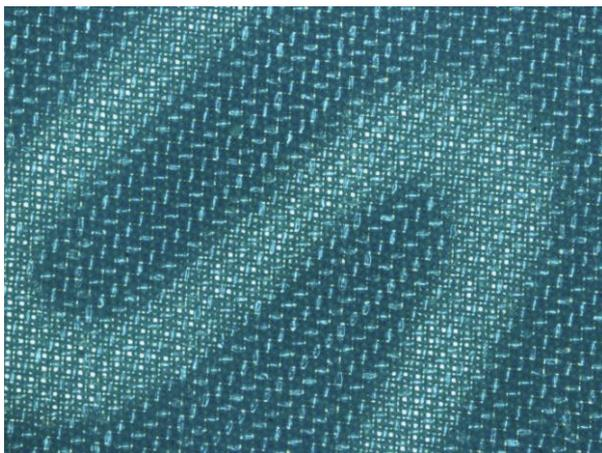
Abb. 57: Die im Lack abgebildete Wendel ist in dieser Darstellung noch gut zu erkennen. Man sieht auch die lichtdurchlässigen Stellen deutlich.
