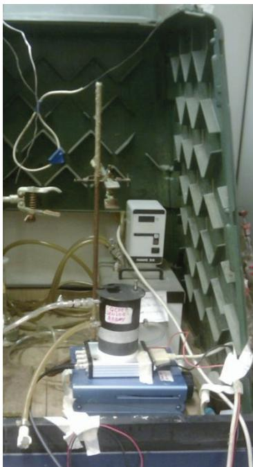
Abb. 11: Messkammer im Abzug in einem Kompostierbehälter
