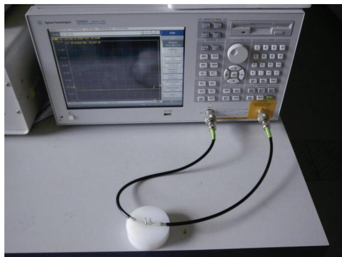
Abb. 13: Netzwerkanalysator, zur Kontrolle der Schwingungsfrequenzen und Phasen der Quarze
