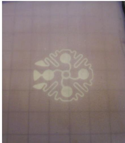
Abb. 31: Quarzsieb mit Fotolack, zu sehen die bereits belichtete und ausgewaschene Struktur.
