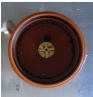
**Abb. 6: Drehteller mit Spritzschutz.**
