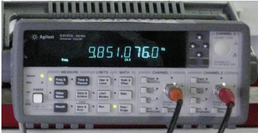
Abb. 12: Agilent Frequenzzähler mit zwei aktiven Kanälen beim Messen einer 10 MHz Quarz Resonanzschwingung
