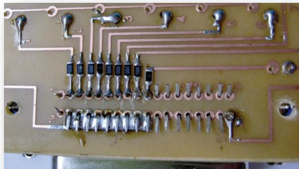
**Abb. 69: Rückseite der Platine auf welcher der LPT-Stecker montiert wurde. Die Anschlusspins wurden verlötet. Gut zu sehen ist die verbundene Lötstelle der Erdungen, sowie die mit einem Nullwiderstand verbundenen Signalleitungen.**
