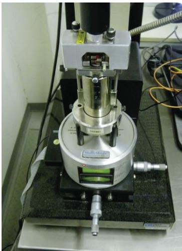
**Abb. 16: AFM-Einheit auf einer Marmorplatte am Luftgefederten Tisch.**
