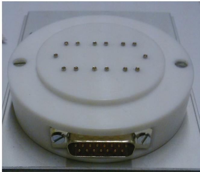
Abb. 82: Teflonplatte mit Steckpins im fertig montierten Zustand am Deckel des Switchgehäuses.
