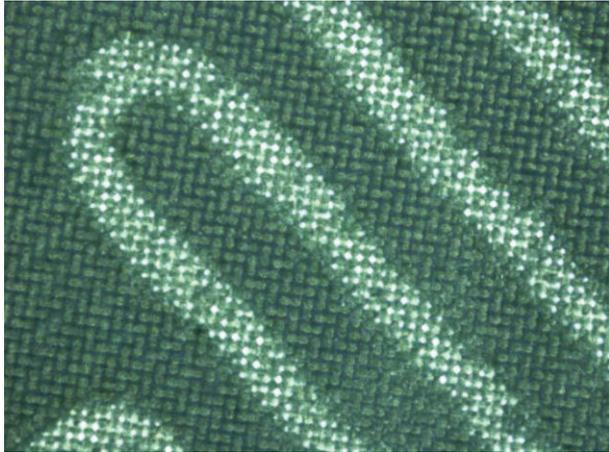
Abb. 63: Die Struktur der Heizwendeln ist sehr eng gestaltet. Es wurde dabei das Limit der Auflösung erreicht. Etwa 1,5 mal der Breite der Wendel, musste der Abstand zur nächsten Bahn entsprechen. Sonst wäre die Struktur bei der Beschichtung ineinander verflossen.
