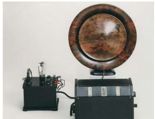
Bild 2: Der erste Philips Radio produziert 1927 – noch mit externem Lautsprecher
