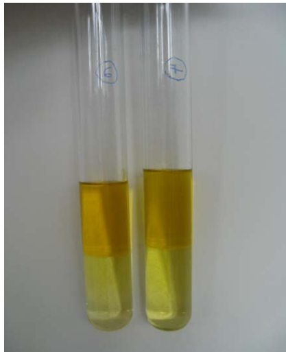
Abbildung 28: Phasentrennung nach Verseifung der Probe 6 und 7 (lt. Tab. 10)
