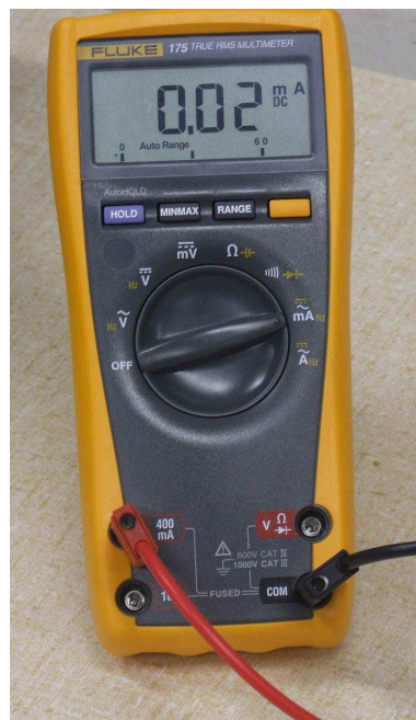
Abbildung 15: Digitalmultimeter als Amperemeter
