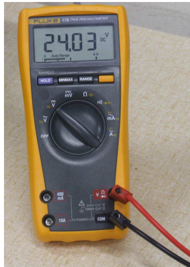
Abbildung 13: Digitalmultimeter misst Gleichspannung
