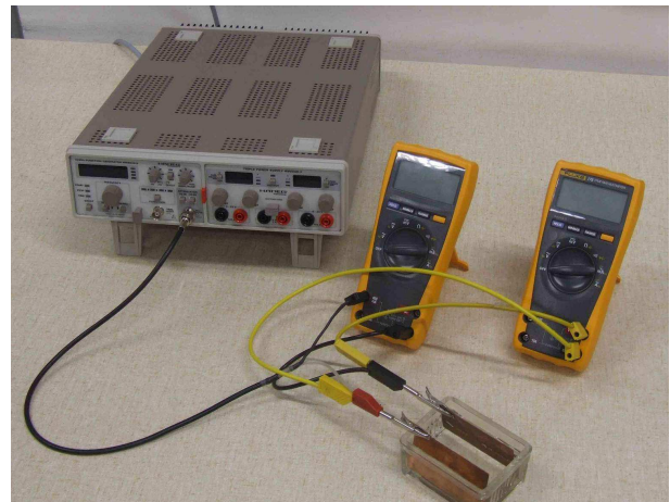
Abbildung 30: Messen von Strom und Spannung
