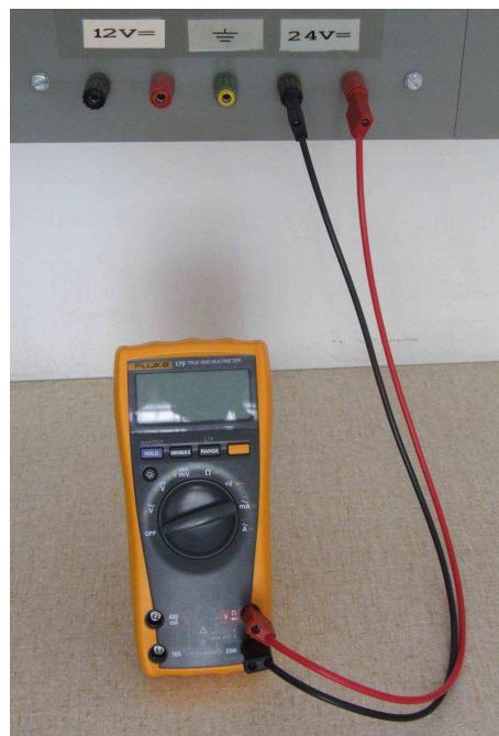
Abbildung 12: Messen der Quellenspannung
