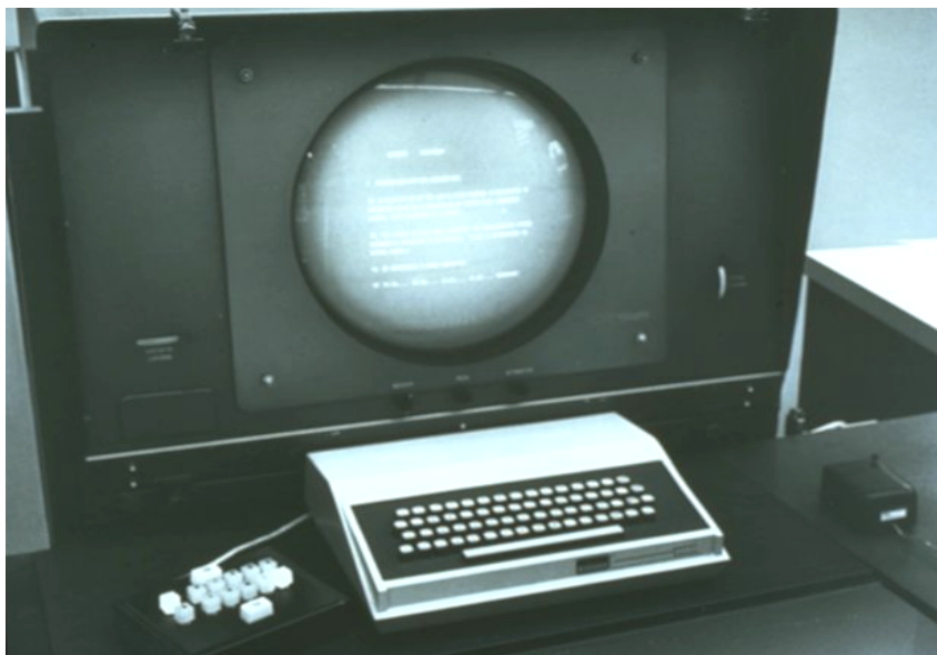
Abb.8: Bildschirmarbeitsplatz, an dem 1963/64 am SRI die Experimente mit grafischen Eingabegeräten durchgeführt wurden; rechts: Maus
