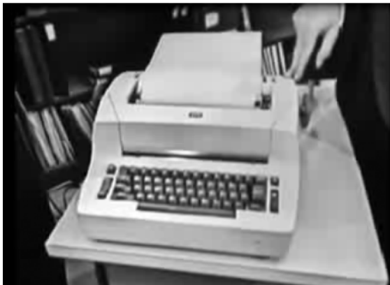
Abb.3: Fernschreiber-Terminal am MIT Computation Center 1963; Bildschirmterminals wurden erst später entwickelt.
