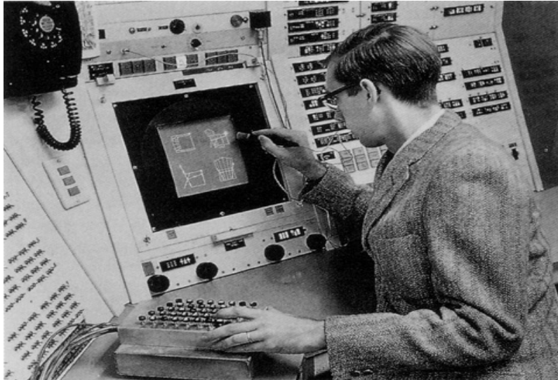
Abb.4: Ivan Sutherland an der Konsole des TX-2 am MIT: Die Bedienung von Sketchpad erfolgte mit einem Lichtgriffel und Kommandoknöpfen (unter der linken Hand). Die vier schwarzen Knöpfe unterhalb des Bildschirms regelten Größe und Position der „Sketches“.
