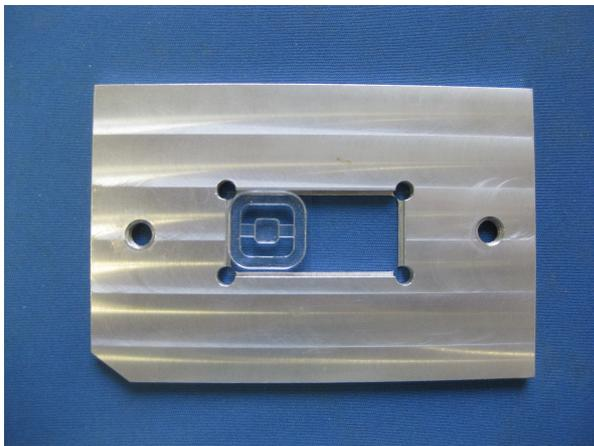
Abb.52: Aluminiumblock mit PDMS-Kanal
