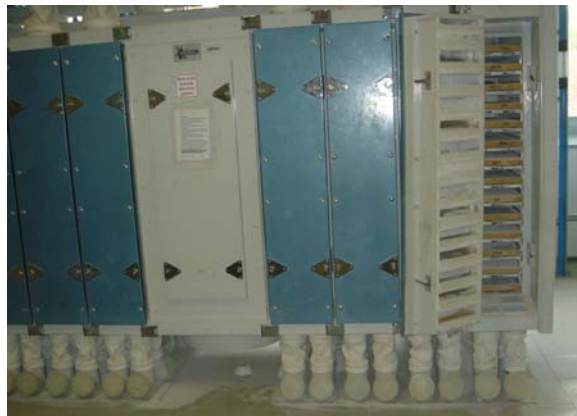
Abb. 8: Plansichter mit sichtbarem Siebstapel
