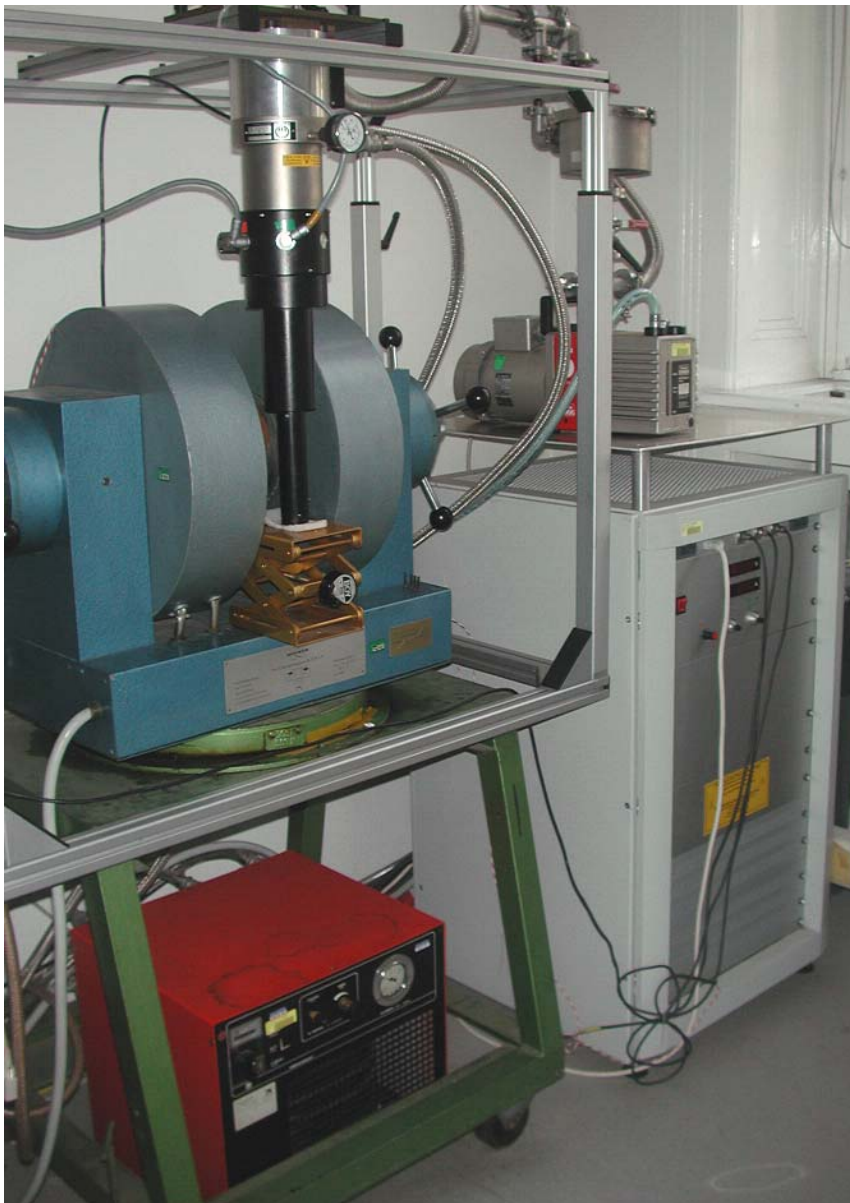
Abbildung 4.1: Darstellung des Messapparatur. Rechts oben befindet sich die Vakuumpumpe auf dem darunter gelegenen Netzteil für den Elektromagneten. In der linken Bildhälfte befindet sich der Elektromagnet mit dem dazwischen befindlichen Closed Cycle in Silber/schwarz. Links unten ist der Helium-Kompressor zu sehen.
