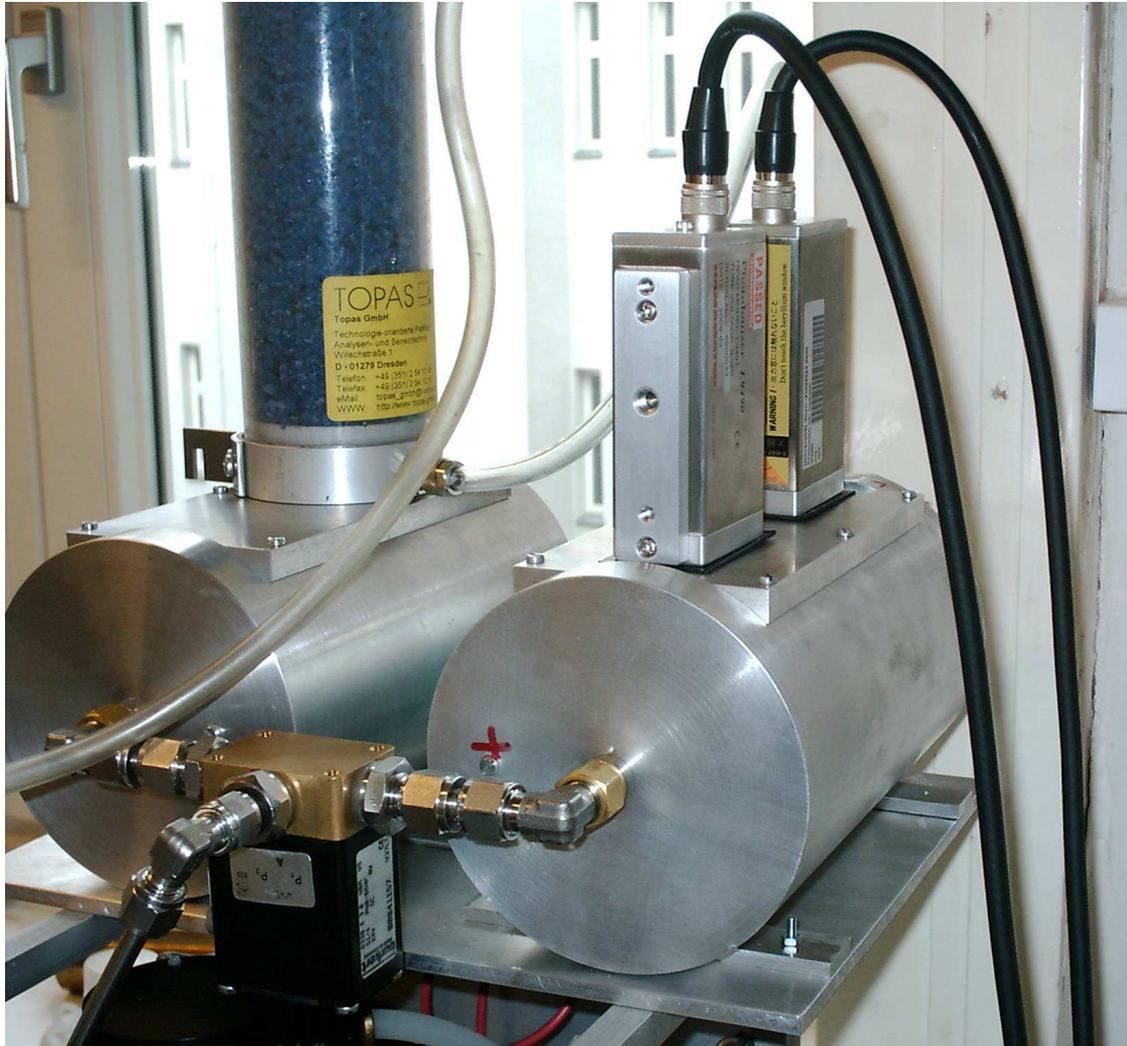
Abbildung 5.6: Weichröntgen-Charger (rechts) und baugleicher radioaktiver Charger (links) im Betrieb mit nachgeschaltetem 3-Weg Magnetventil (vorne)
