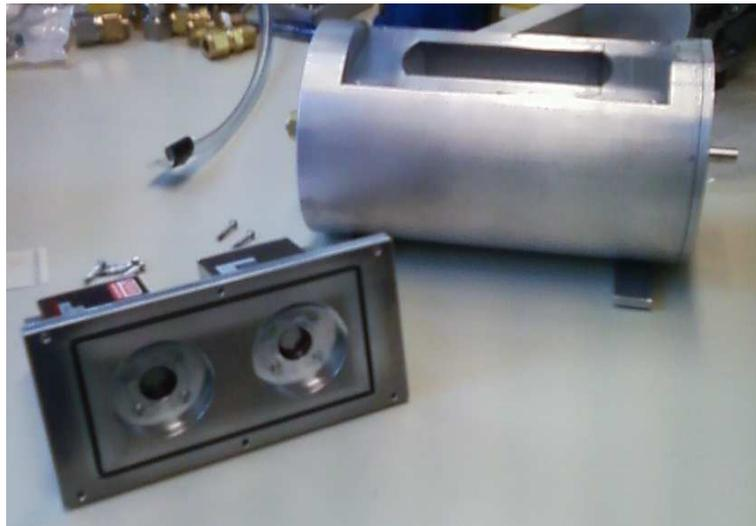
Abbildung 5.4: Geöffnete Ionisationskammer (rechts hinten) sowie Deckplatte mit montierten Photoionizern (links vorne)
