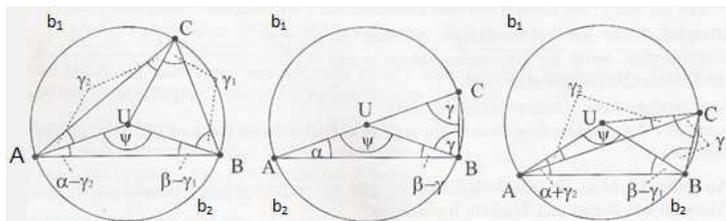
Abbildung 5.6: Peripheriewinkelsatz
