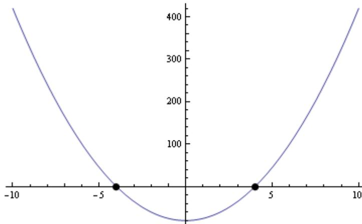
Aus der Zeichnung wird sofort ersichtlich: Die zugehörige Funktion  $y = 5x^2 - 80$  besitzt zwei Nullstellen, d.h. zwei Schnittpunkte mit der x-Achse.
