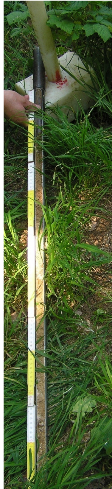
Abbildung 2.1-02: PÜRCKHAUER-Bohrer mit Profil Han02 Kunststoffhammer, Zollstock
