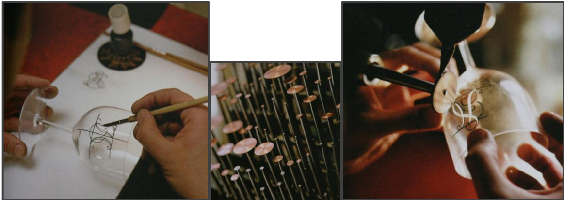
Abb. 23: Schnitt: Kupferrädchen; Vorbereitung und Durchführung des Schnitts
