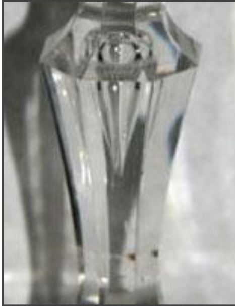
Abb. 47: Detail der eingeblasenen Luftblase an Kelchglas 3. Gr. Des TS 98
