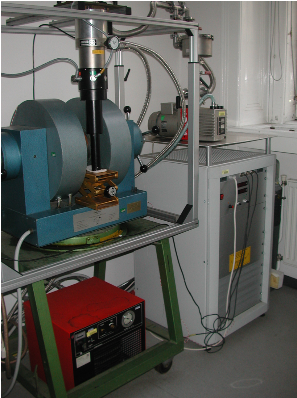
Abbildung 7.1: Der geschlossene He-Kühlkreislauf, der Elektromagnet, die Vakuumpumpe und die Stromquelle für den Magneten.
