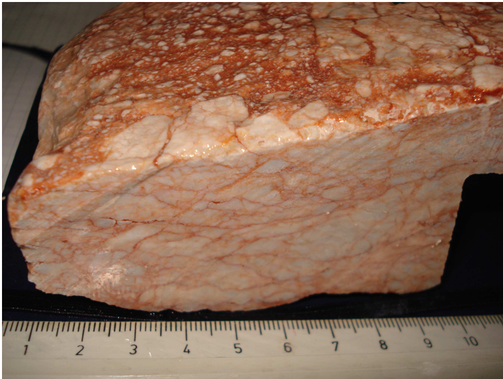
Abb.14 Drucklösungsbreccie aus dem Störungskern der Störungszone A5/ Griesgassl im Wettersteinkalk
