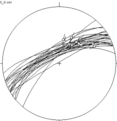
Abb. 19 Harnischflächen der Hauptstörung A3/Unterer Ring im Wettersteinkalk
