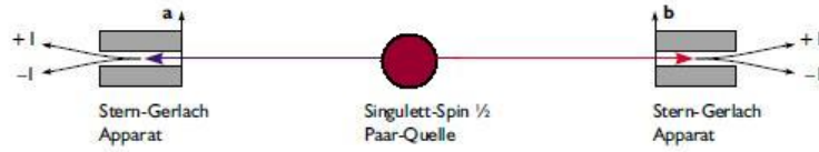
Abbildung 2.1: Schematische Darstellung eines Bell-Gedankenexperiments
