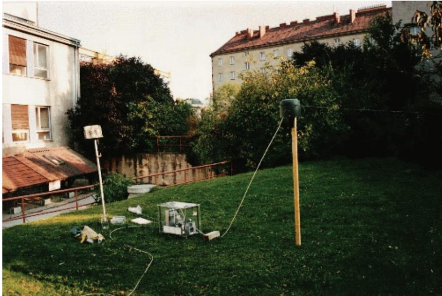
*Abb. 15: Gentsammler - Anordnung (Standort Rinnböckstrasse) mit der Pumpeneinheit am Boden stehend und der gestapelten Filtereinheit die an einem Holzpfahl befestigt wurde. Auf der linken Seite sieht man auch den Bergerhoffsammler.*
