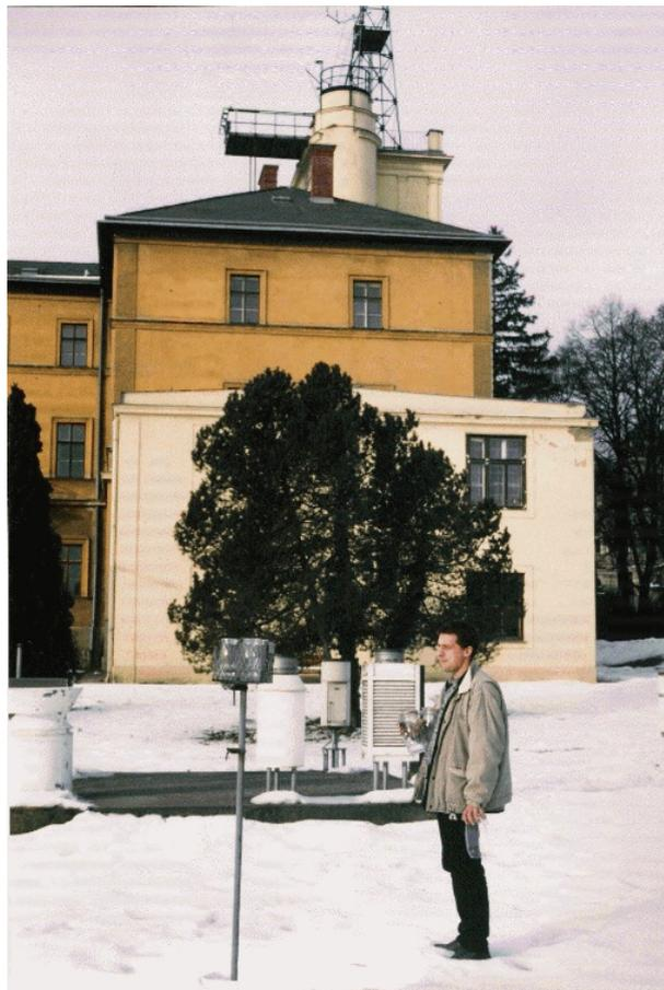
*Abb.14: Bergerhoffsammelgerät am Standort Hohe Warte. Im Hintergrund das alte Gebäude der Zentralanstalt für Meteorologie und Geodynamik und zwischen Bergerhoffsammler und Gebäude ist die Außenmessstation der ZAMG zu sehen.*
