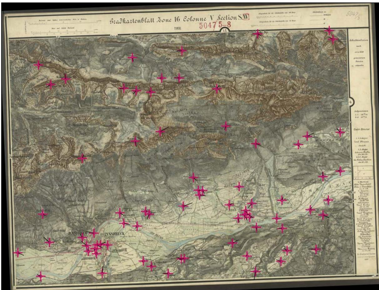
Abb. 30: Fehlervektorendarstellung der Dritten Landesaufnahme (1873) von Innsbruck (Fehlervektoren 10x vergrößert)
