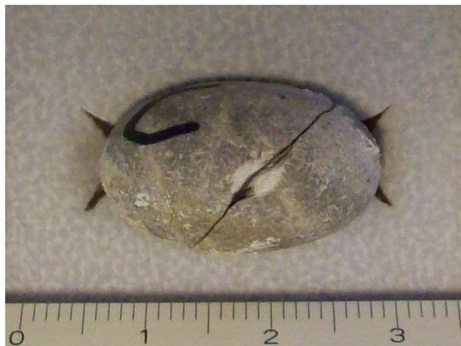
Abbildung 6.18 Zerbrochene Einzelkomponente mit Drucklösung
