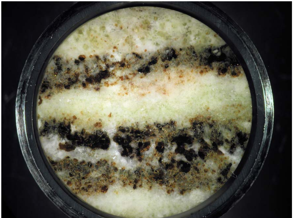
Abbildung 32: Anschliff eines typischen, mit Sphalerit (dunkelbraun bis schwarz) vererzten Silikatmarmorstückes, aus Kochholz. Der alterierende Lagenbau ist gut zu erkennen.
