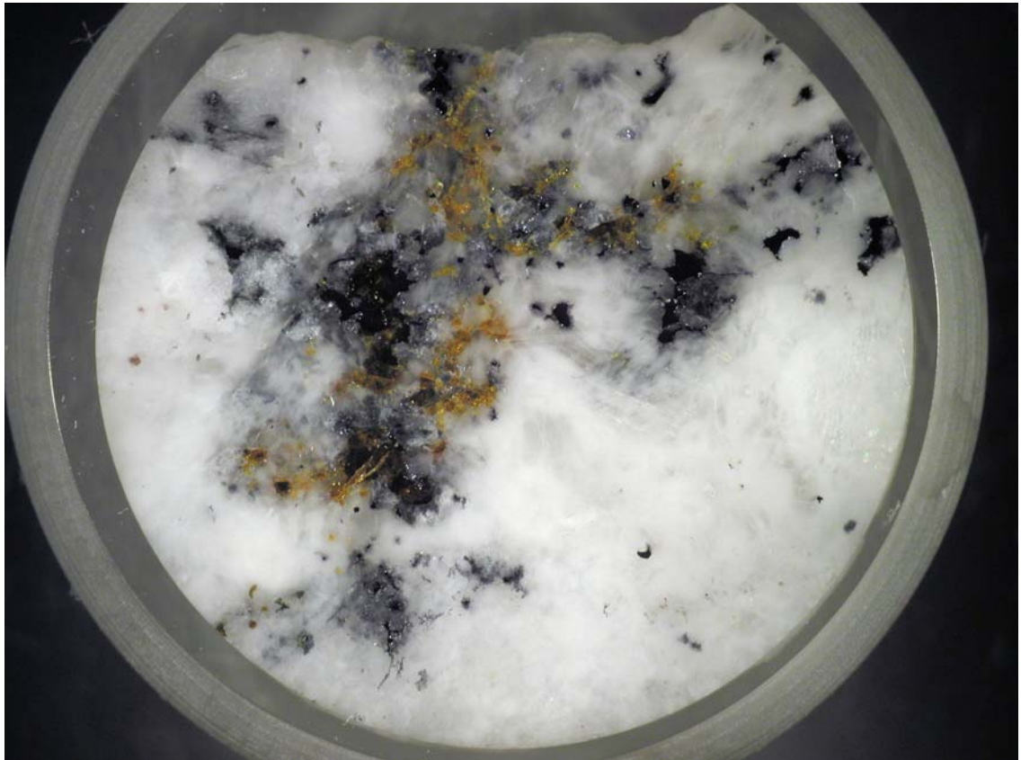
Abbildung 38: Anschliff eines typischen mit Sphalerit (ocker) und Galenit (silbrig-schwarz) vererzten, weißen Marmorstückes aus Winkl.
