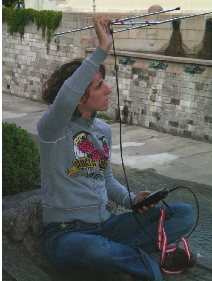
Abbildung 2: Homing in. Empfangsgerät mit H-Antenne. Die gesuchte Richtung wurde durch ein verstärktes Sendesignal angezeigt. Wiener Stadtpark. Foto: Alexander Schindler
