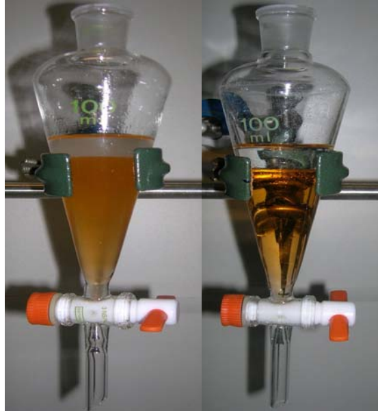
Abb. 4: Die Phasentrennung im Scheidetrichter vor (trüb) und nach dem Unterspritzen von Methanol (klar)
