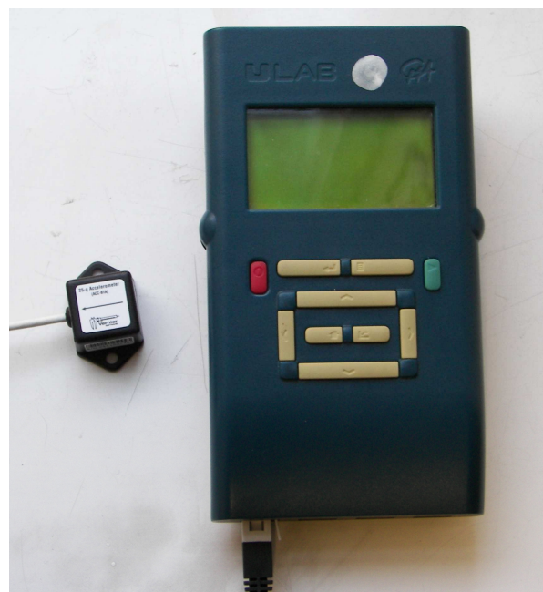
Abb. 26: ULAB mit Beschleunigungssensor
