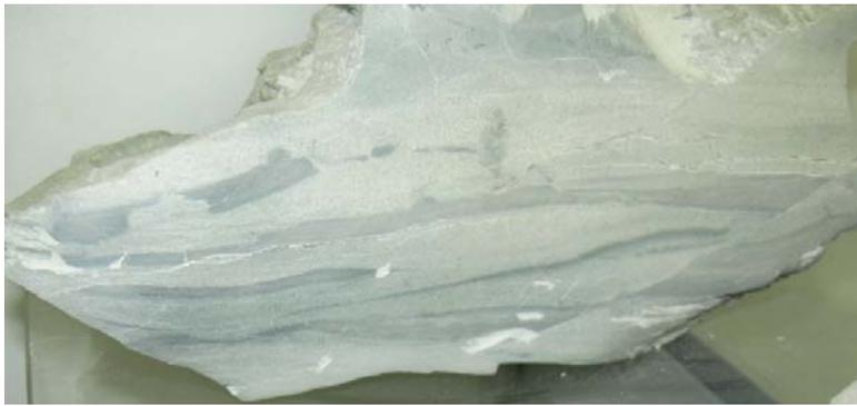
**Abb.15** vulkanische Aschelage Vortriebsmeter 548,4
