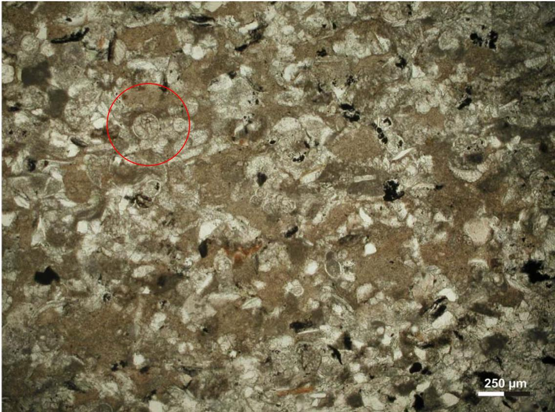
**Abb.23** Sandstein, Probe 470,4/li2, 5-fache Vergrößerung, ungefärbt, globigerinenartige Foraminifere im gekennzeichneten Bereich
