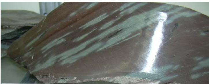
**Abb. 14** Tonstein rot-grüne Wechselfolge Vortriebsmeter 539,3 mit anpolierter Fläche (untere Bildkante: ca. 10cm)
