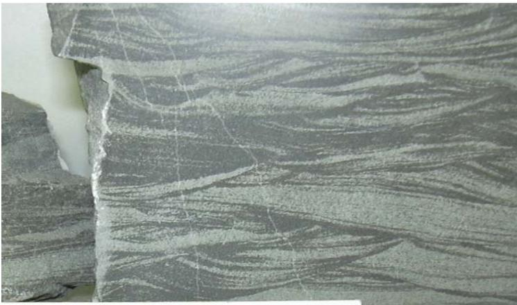
**Abb. 13** Sandstein mit Kreuzschichtung Vortriebsmeter 463,9 (untere Bildkante: ca. 10cm)
