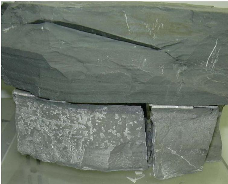
**Abb. 12** Tonmergel-Mergel-Wechselfolge Vortriebsmeter 457,4 Mergel feinsandig laminiert (untere Bildkante: ca. 20cm)
