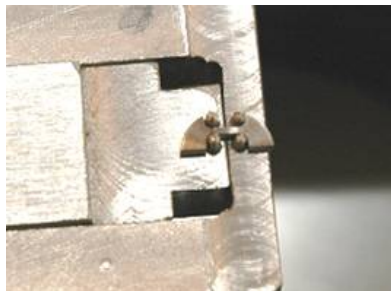
Abbildung 22: Miniaturzugmaschine mit hantelförmiger Probe. Die Dehnung der Probe erfolgt durch Bewegung des mittleren Teils nach links [50].
