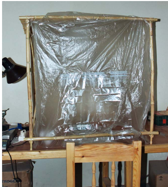
Abb. N: „Probenvorbereitungsraum“: ein ca. 1m 3 großer Luftraum, der mit Wasserdampf aufgesättigt wurde.
