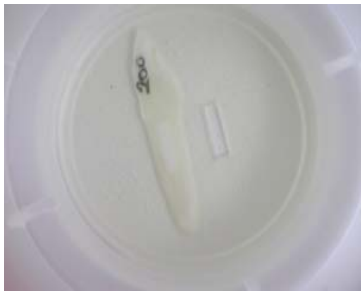
Abb. 2: Silikonmatte in Bottle Top fixiert. Mit Unterdruck angesaugte Dentinscheibe mit deutlich sichtbarem 2mm x 8mm Durchziehbereich
