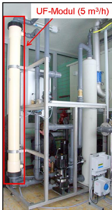
**Abb. 7.22: Aufnahme der kleintechnischen UF-Membrananlage.**
