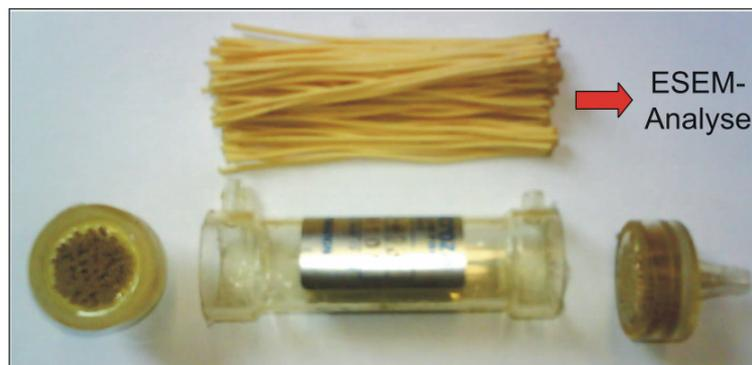
**Abb. 7.32: Sezierung eines Membranmoduls vom Typ B zur Isolierung der Singlebore-Membranen zur ESEM-Analyse.**
