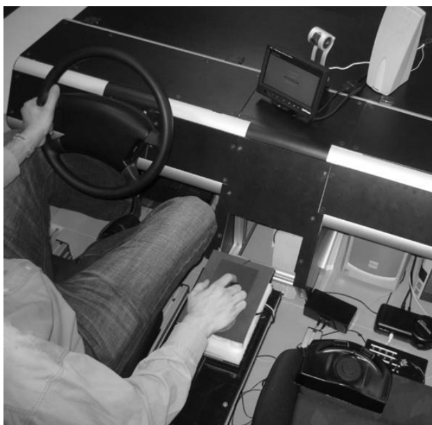
Abbildung 11: links: Cockpit Mock-up; rechts oben: Touchpad mit Handballenauflage (Oberseite); rechts unten: Körperschallwandler und Elektromotoren mit Unwucht für taktilen Feedback (Unterseite).
