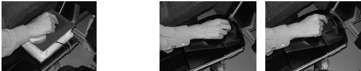
Abbildung 8: Eingabe mit Hilfe eines Touchpads (links) und eines Dreh-Drückstellers (rechts). Für Selektions- und Bestätigungsbewegungen kann bei Touchpads dieselbe Handstellung beibehalten werden.
