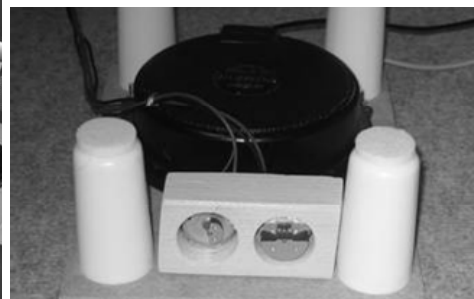
Abbildung 11: links: Cockpit Mock-up; rechts oben: Touchpad mit Handballenauflage (Oberseite); rechts unten: Körperschallwandler und Elektromotoren mit Unwucht für taktilen Feedback (Unterseite).
