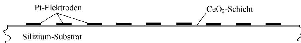
Abbildung 7.6: Skizze der untersuchten Pt/CeO 2 /Si-Kondensatoren. Auf dem Silizium-Substrat (Wafer oder Waferbruchstück) befindet sich eine ganzflächige CeO 2 -Schicht. Über eine Schattenmaske wurden Platin-Elektroden aufgedampft, die Rückseite des Siliziums wird mit einem Eutektikum kontaktiert.
