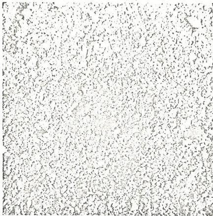
Abb. 8: Oberfläche des Testmaterials, gegen Zinnfolie polymerisiert (Vergr.: 200 x)
