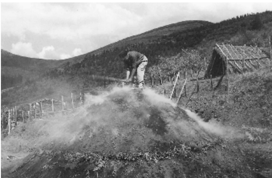
Fig. 8.- Con la "mandarria" se golpea la corona para compactar el carbón.
