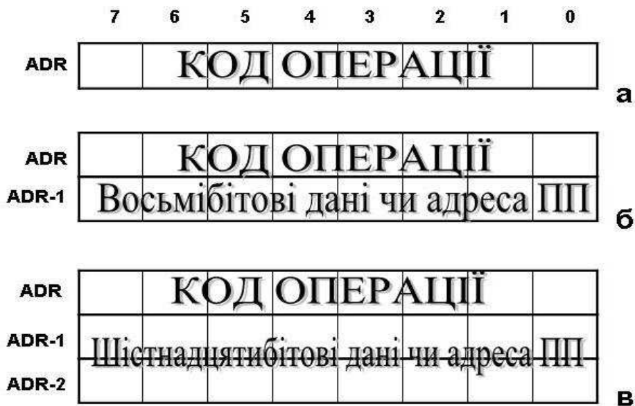
Рис.8.2 – Формат команд: а – одно-; б – дво-; в – трибайтовий
