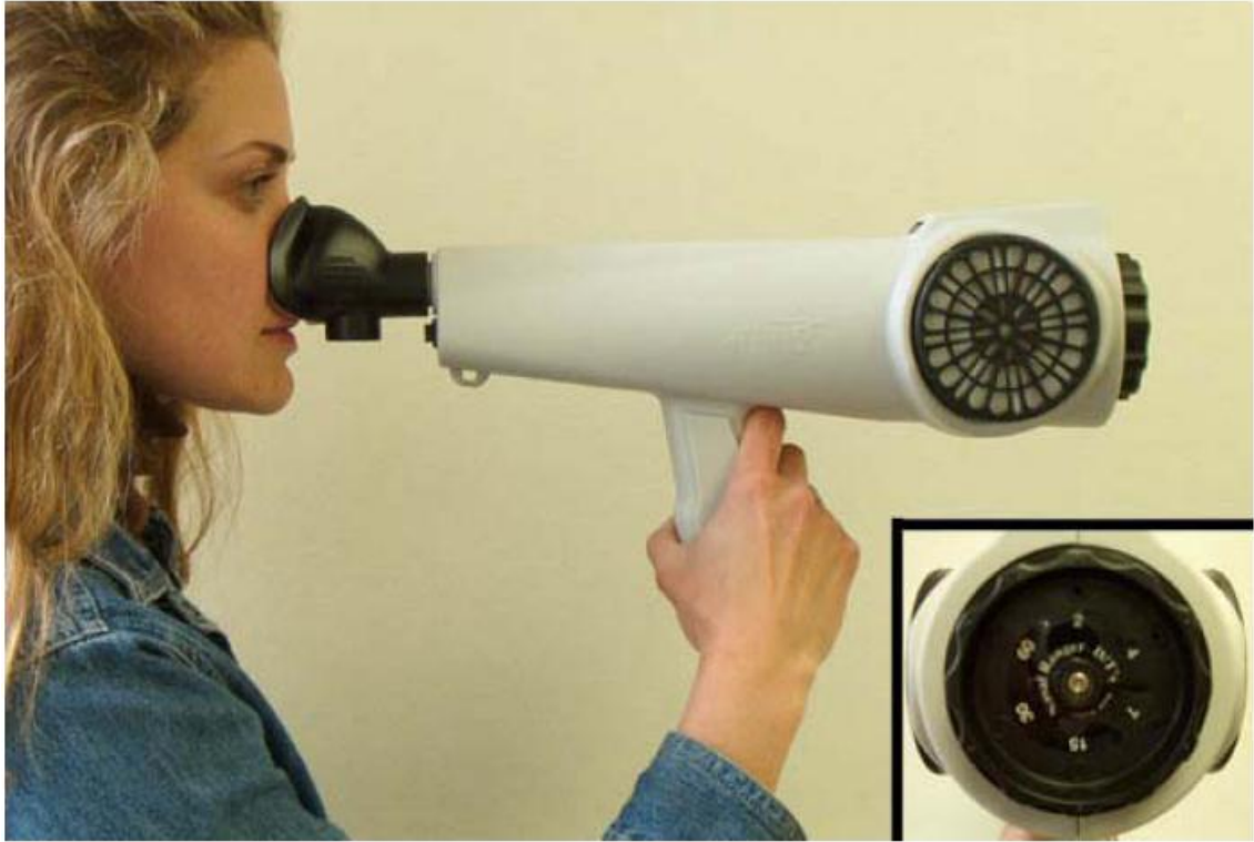
Fig. 1-1: Nasal range olfactometer [20]
