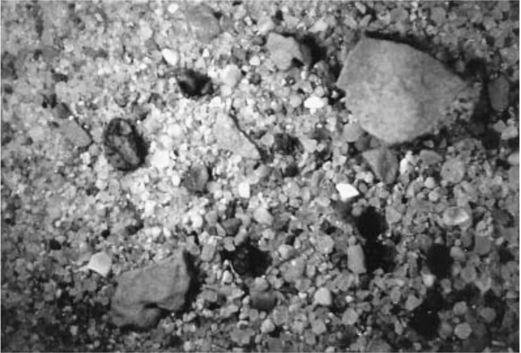
Fig. 5. Foto allo stereomicroscopio dell'aggregato sabbioso separato dal legante - Ingr.6,5x
