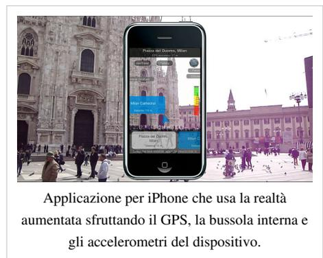
Applicazione per iPhone che usa la realtà aumentata sfruttando il GPS, la bussola interna e gli accelerometri del dispositivo.
