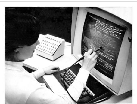
Prototipo di una console per ipertesto del 1969
