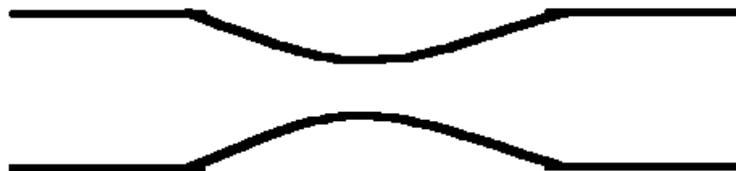
Se il condotto diminuisce di sezione, la velocità aumenta e la pressione diminuisce.
