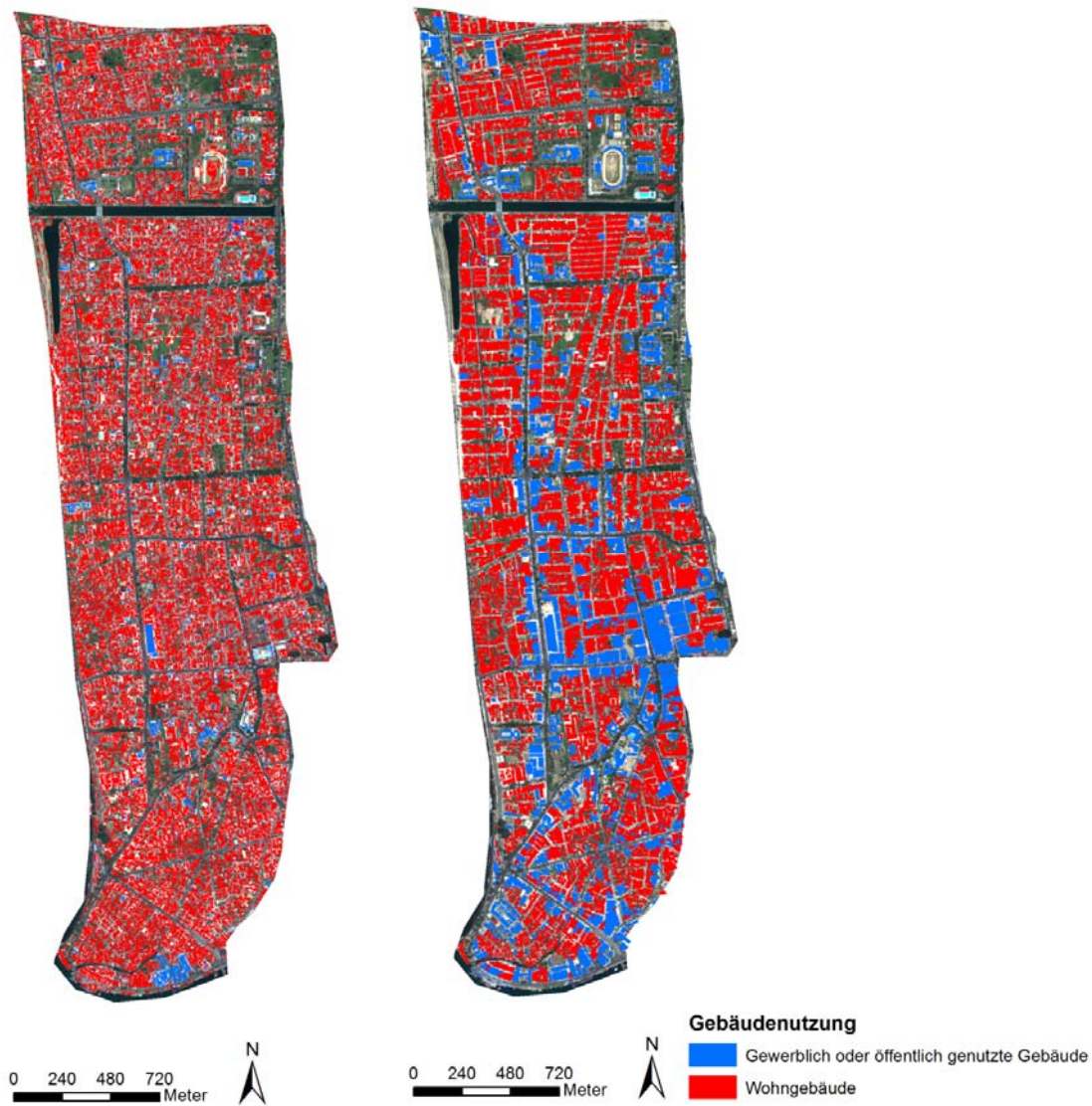
Abb. 5.4 Validierung der Gebäudenutzung. Links: Aus Fernerkundungsdaten abgeleitete Gebäudenutzung. Rechts: Mit Hilfe von Stichproben („Last-Mile-Evacuation“/ DLR) erhobene Gebäudenutzung
