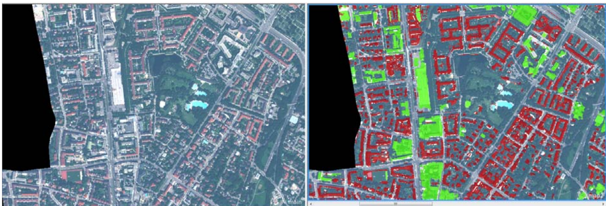
Abb. 4.5 Ausschnitt des Satellitenbildes und erstellten Gebäudemasken im Stadtteil Altstadt-Lehel mit Wohngebäuden (rot) und Industriegebäuden (grün)
