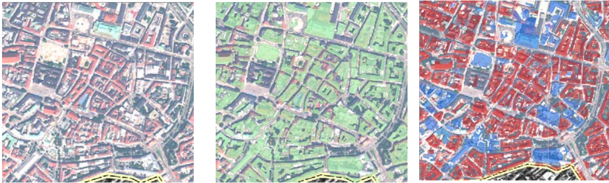
Abb. 5.2 Ausschnitte des Satellitenbildes (links), abgeleiteten Gebäudemasken (Mitte) und Klassifikation der Wohn- (rot) und Industriegebäude (blau) in München (rechts)
