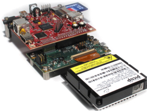
Abbildung 3.4: Pico development kit bestehend aus beagleboard (rote Platine), PDE-Beagleboard Interface-Modul (grüne Platine) und display engine [16]
