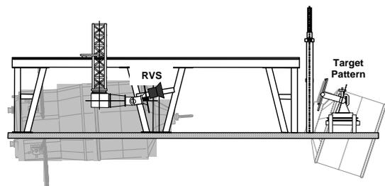
BILD 3 Prinzipbild zum Einsatz der früheren EPOS-Anlage für ATV-RvD-Tests
