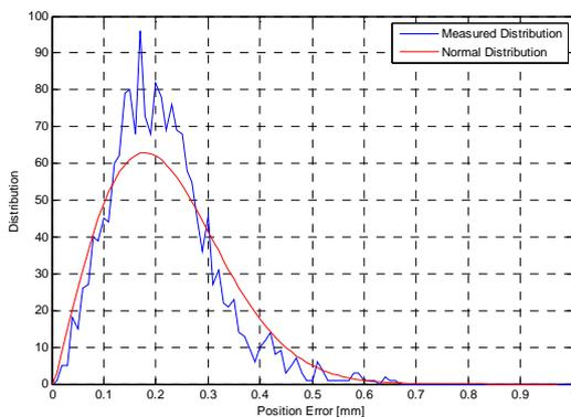
BILD 12 Vermessene Positioniergenauigkeit des Roboter 2 (KR 100 HA)
