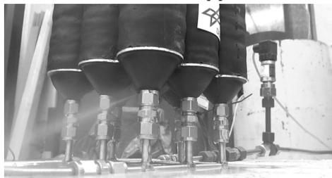
Abbildung 14: Druck-Zeit Verlauf des Berstversuches und Versagensbild
