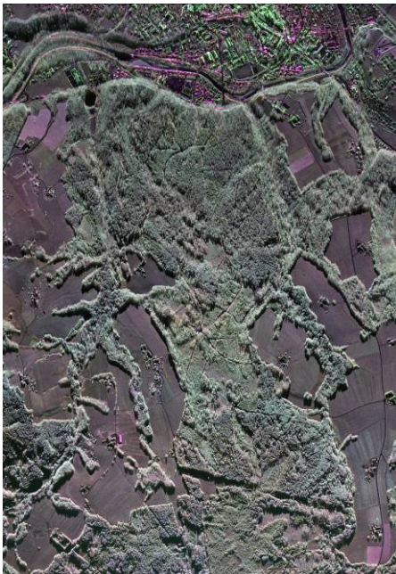
Abbildung 1-2 Der Wald und landwirtschaftlich genutzte Flächen bei Traunstein, in Bayern, im X-Band (Wellenlänge \lambda = 3\text{ cm} ; links), Waldgebiet in Remningstorp in Schweden im P-Band (Wellenlänge \lambda = 85\text{ cm} , rechts)
