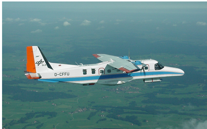
Abbildung 1-1 Das flugzeuggetragene Synthetik-Apertur-Radarsystem, auf Do 228
