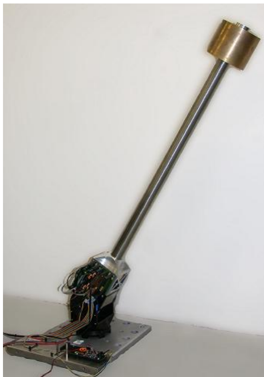
Abbildung 3.6.: Gelenkidentifikationsprüfstand zur Identifikation der Gelenkparameter beim LBR [4]
