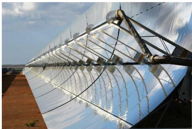
**Bild 1: Parabolrinnen-Kollektor im Betrieb (Andasol-1)**
