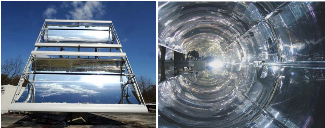
Bild 1: links: Solarer Receiverprüfstand (SolaRec) zum simultanen Testen von 2 Receivern; rechts: Elliptischer Sonnensimulator-Receiverprüfstand (ElliRec, Innenansicht)
