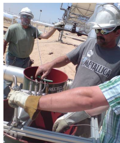
Abbildung 1: Links: Apparatur zur Entnahme von Ölproben; rechts: Anlage im Feldbetrieb.
