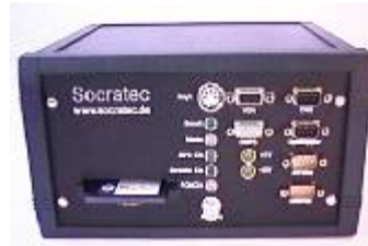
Abbildung 51: SaturnLight – Beispiel eines Zuglokalisierungssystems der DB-AG in Kombination von GPS mit Inertialsensorik [Rails01].
