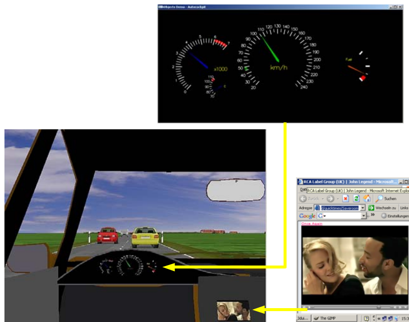
Abb. 1: Ein mit CoEDiT erstelltes Szenario wird mit RaSCal in die VRE integriert. RaSCal arbeitet formatunabhängig und ermöglicht auch die Anzeige anderer Bilder/Videos in der Simulation.
