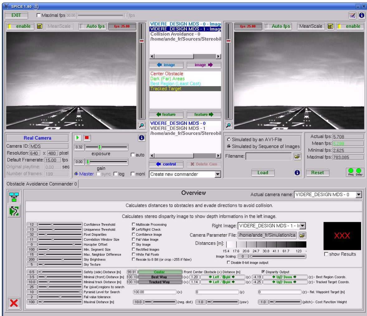
Abbildung 3.2: Screenshot der spice -Bildverarbeitungsumgebung. Im oberen Bereich befindet sich links und rechts jeweils ein Fenster zur Bildanzeige. Dort ist die Darstellung beliebiger geladener und verarbeiteter Bilder möglich. Im unteren Bereich erfolgt die Steuerung der Bildverarbeitungsoperationen.
