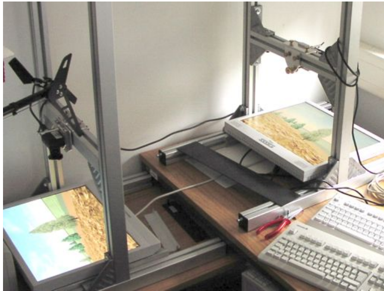
Abbildung 6.2: Laboraufbau der Sichtsimulation. Es erfolgt eine Anzeige von zwei Sichten auf LCD-Flachbildschirme. Die Kameras sind so positioniert, dass der Rand des Bildschirme nicht zu sehen ist und die Bilder nicht verwackeln. Schutz vor Außenlicht wird über dunkle Abdeckungen realisiert, die hier nicht zu sehen sind.
