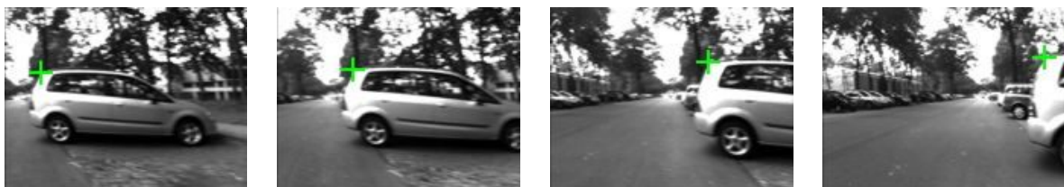
Abbildung 2.12: Verfolgung eines Musters in einer Bildsequenz. Die grün gekennzeichnete Ecke des Fahrzeugs wird, einmal ausgewählt, in den Folgebildern wiedererkannt.
