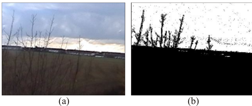
Abbildung 4.7: Segmentierung eines Bildes (a) in Himmel und Erde. Bildpunkte, die dem Himmel zugeordnet werden, sind weiß dargestellt (b).
